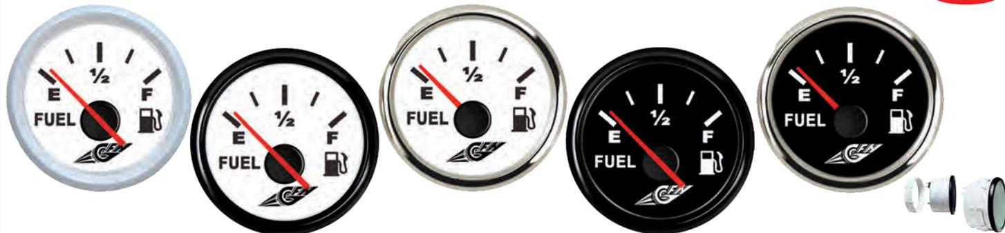
Indicatore di livello carburante ad incasso, **stagno IP67**, dotato di illuminazione notturna. Carcassa in tecnopolimero, vetro anti-fog, cornice in **ACCIAIO INOX AISI L** lucido o verniciato.
